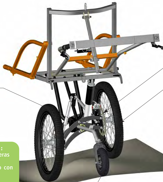
Rueda jockey Ø190 amovible y/o escamoteable Ruotino d'appoggio Ø190 estraibile e/o retrattile
